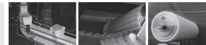
Las bandas de plástico modulares, las bandas termoplásticas así como las bandas de malla de acero o de alambre se accionan por tracción positiva, es decir, sin tensar la banda. Dado que la banda no tiene apenas contacto directo con el tambor, la disipación de calor es menos eficaz en estas aplicaciones. Para tales aplicaciones recomendamos utilizar un mototambor asíncrono eficiente con un alto rendimiento o utilizar un mototambor síncrono.
