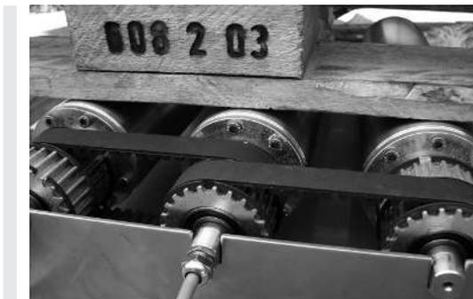
En aplicaciones sin banda transportadora o con una banda estrecha que cubre menos del 70 % del ancho del mototambor, el calor del motor no puede evacuarse a través de la banda. Para tales aplicaciones recomendamos un mototambor asíncrono o un mototambor síncrono de 2 polos con un convertidor de frecuencia.
