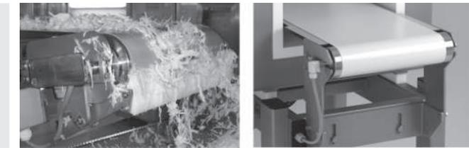
Las bandas accionadas por fricción son accionadas mediante la fricción entre el mototambor y la banda transportadora. Por lo general, el mototambor es de tipo abombado para impedir una desviación de la banda. La banda debe tensarse para que pueda transmitirse el par motor del mototambor. La superficie de la banda puede ser plana, lisa o estar dotada de nervios, ranuras o rombos.
