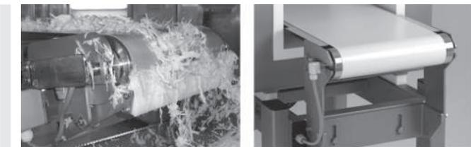
Les bandes à entraînement par friction sont entraînées par la friction produite entre le tambour moteur et le convoyeur à bande. Le tambour moteur est généralement de forme bombée, afin d'éviter tout désalignement de la bande. La bande doit être tendue afin de transmettre le couple du tambour moteur. La bande peut être pourvue d'une surface plate, lisse, avec rainures ou losanges.
