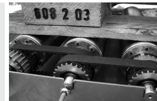
En cas d'applications sans convoyeur à bande ou avec une bande étroite qui couvre moins de 70 % de la longueur des tambours moteurs, la chaleur ne peut pas se dissiper via la bande. Pour ce type d'applications, nous recommandons d'utiliser un tambour moteur asynchrone à 2 pôles ou un tambour moteur synchrone avec un variateur de fréquence.
