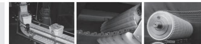
Les bandes en plastique modulaires, bandes thermoplastiques ainsi que les bandes en tressage acier ou en fil métallique sont transportées par entraînement positif, c'est-à-dire sans charge radiale. La bande n'étant que très peu en contact avec le tambour, la dissipation de chaleur est moins efficace pour ces applications. Pour de telles applications, nous recommandons l'utilisation d'un tambour moteur asynchrone à haut rendement ou l'utilisation d'un tambour moteur synchrone.
