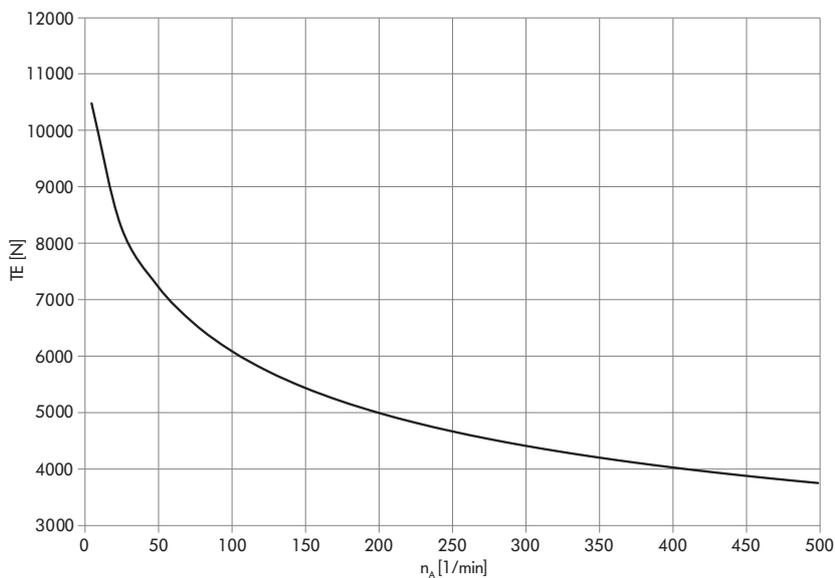
**Remarque :** la valeur exacte de la charge radiale maximale admissible se calcule à l'aide de la vitesse de rotation du tambour moteur. Lors du choix d'un moteur, vérifier que la valeur TE maximale admissible de la longueur de tambour souhaitée (FW) convient à l'application. Les diagrammes des charges radiales s'appliquent uniquement aux axes normaux.
