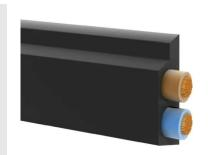
Il cavo piatto serve per l'alimentazione elettrica del ConveyorControl e della MultiControl. Il bordo esterno del cavo è conforme allo standard AS-Interface. La guaina del cavo sigilla i fori creati dai contatti piercing. In pratica, il cavo conserva il grado di protezione anche dopo aver scollegato l'unità di controllo.
